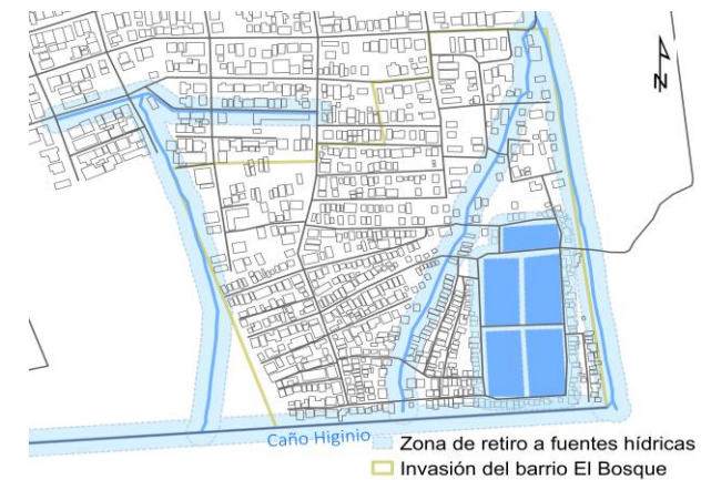
Figura. 21 Vista en planta del asentamiento. Esta grafica identifica las viviendas que se encuentran en zona de retiro a fuentes hídricas
