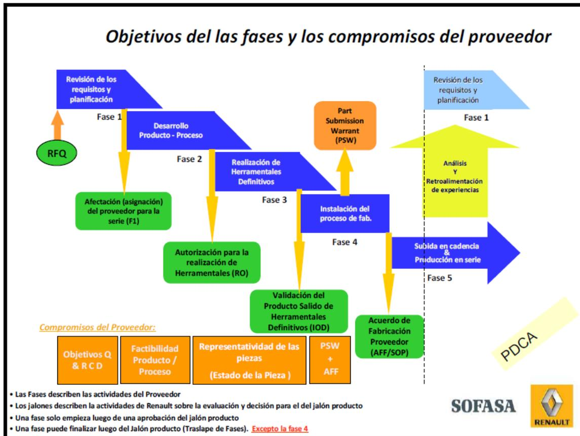
Figura 9. Esquema de la metodología ANPQP con objetivos de fases y procedimientos (Molina, 2009).
