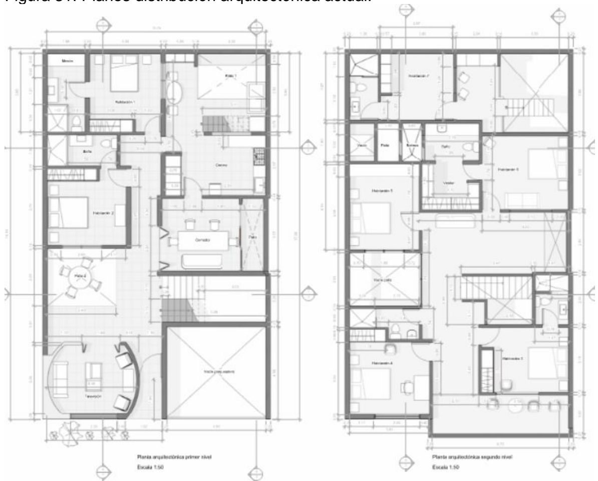
Figura 31. Planos distribución arquitectónica actual.
