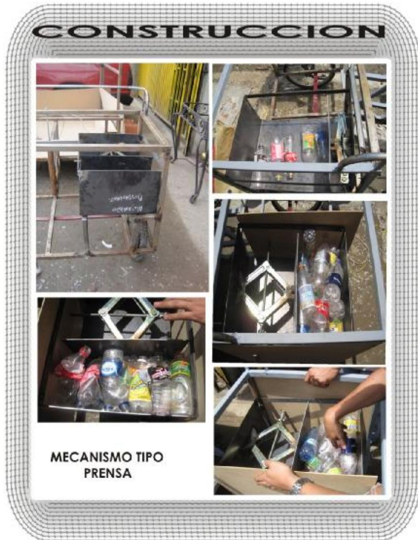
**Figura 42.** Mecanismo Tipo Prensa. Autoría Propia
