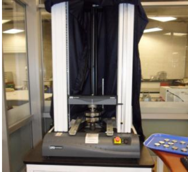
Imagen 13. Maquina universal de ensayos mecánicos, INSTRON
