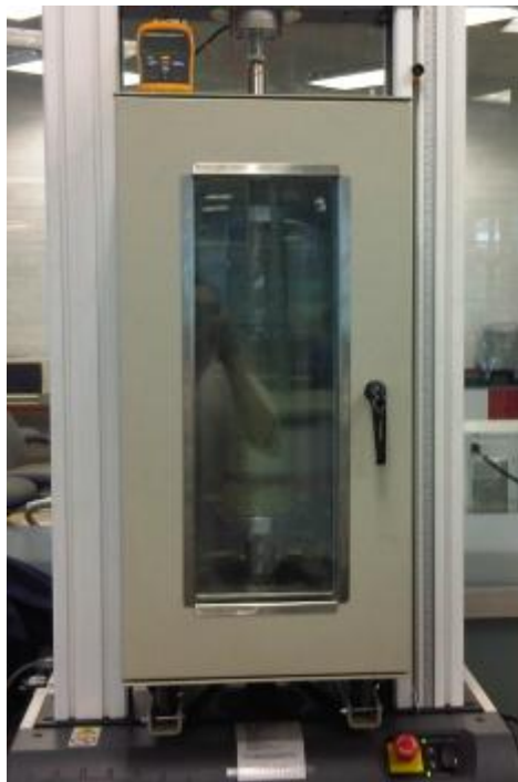
Imagen 14. Cámara de temperatura instalada en la INSTRON
