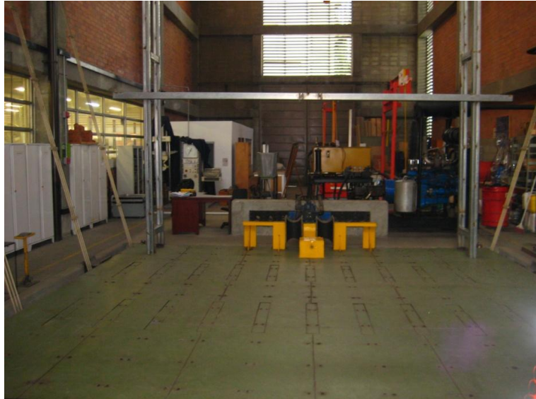
Figura 5.1. Mesa Vibradora del laboratorio de sismica de la Universidad EAFIT
