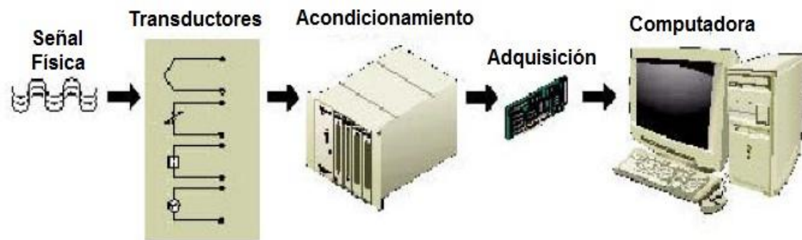
Figura 2.1. Sistema de monitoreo y control de vibración en computadora, a través de una tarjeta de adquisición de datos, acondicionamiento de señal y transductores (Pernia, 2004)
