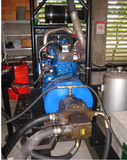
Figura 5.2. Motor Diesel de la mesa vibradora
