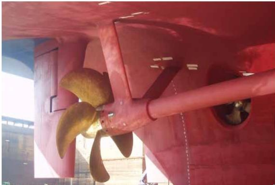
Ilustración 18 Hélice sistema de propulsión
