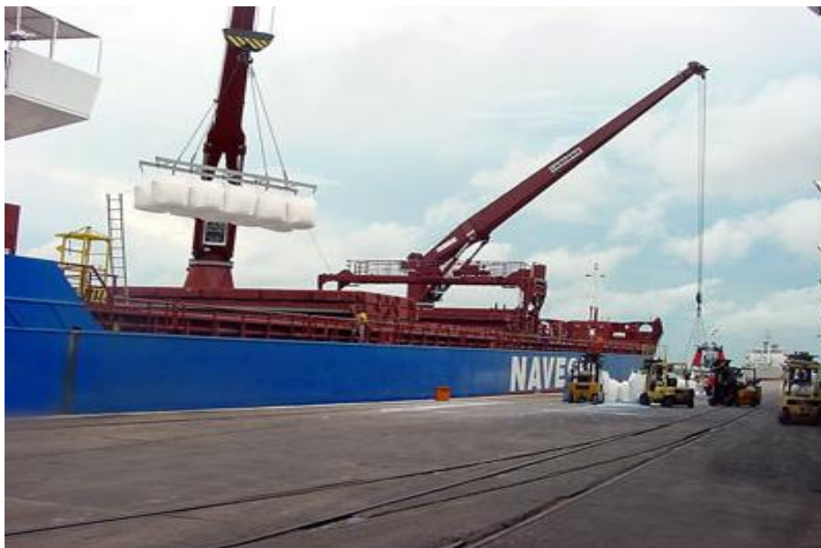
Ilustración 42 Sistema de cargue y descargue del buque
