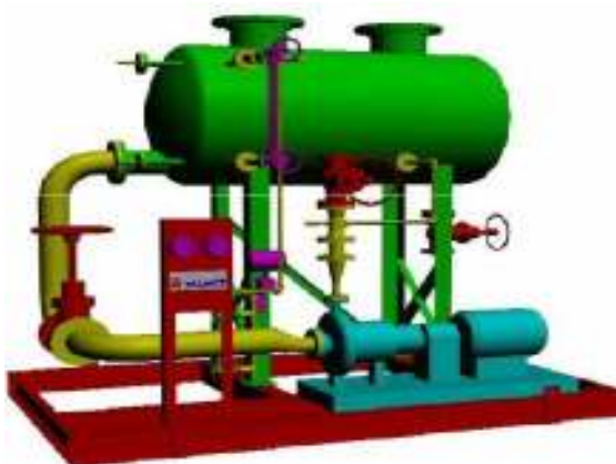
Ilustración 28. Tanque principal recolector de condensados.
