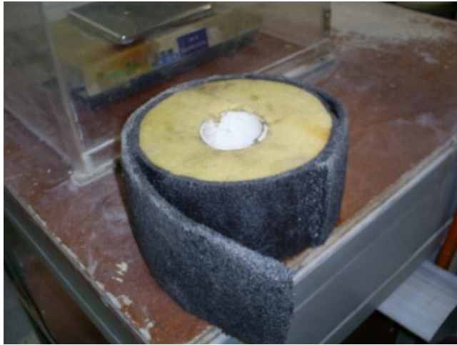
Fotografía 15. Espuma de PE dañada
