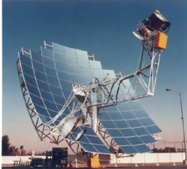
Figura 10. Sistema “Sun Catcher” producido por SES (Stirling Energy Systems).
