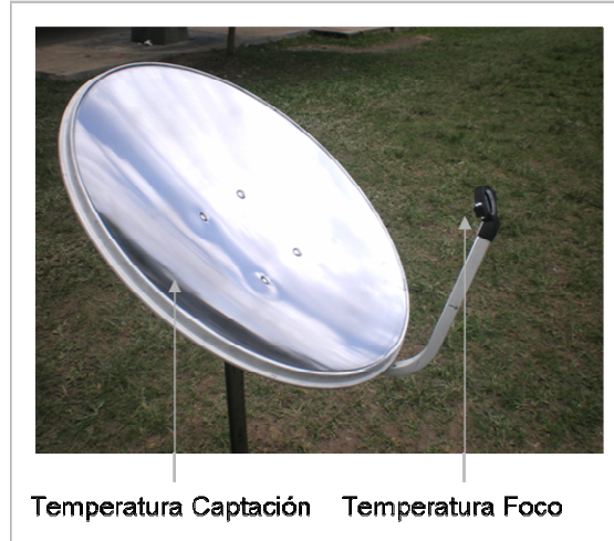
Figura 56. Concentrador solar y puntos de medición de temperatura.
