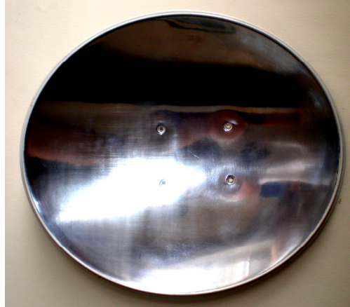
Figura 15. Imagen del espejo paraboloide usado para el proyecto.
