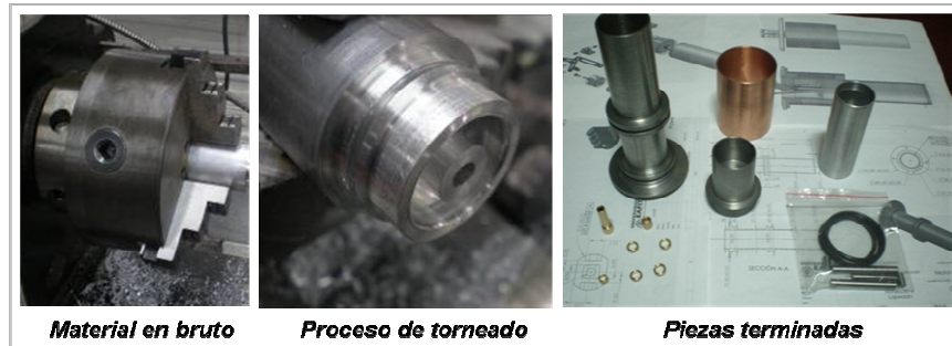
Figura 46. Proceso de manufactura en el torno.
