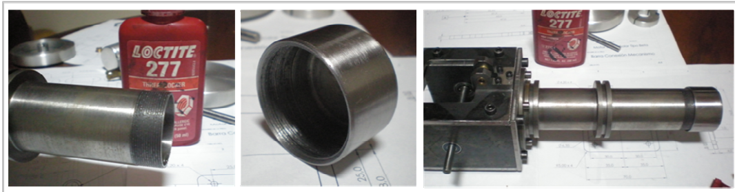
Figura 51. Piezas unidas con Loctite 277.
