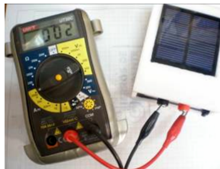
Figura 57. Celda fotovoltaica y multímetro para medir variaciones de radiación.
