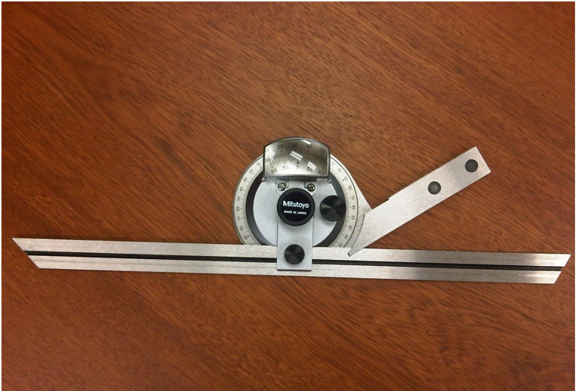
Figura 25. Goniómetro universidad EAFIT
