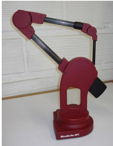
Figura 17. Brazo digitalizador universidad EAFIT
