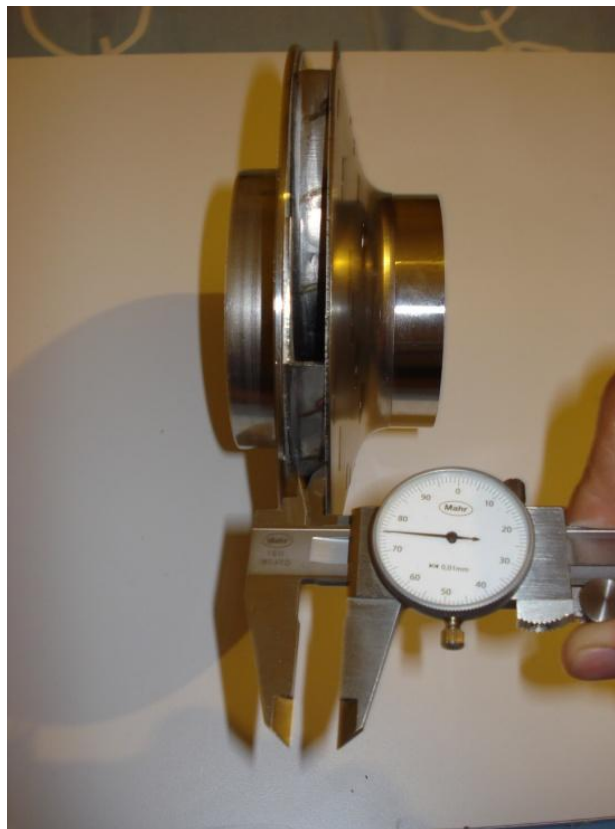
Figura 41. Medición de la separación entre tapas
