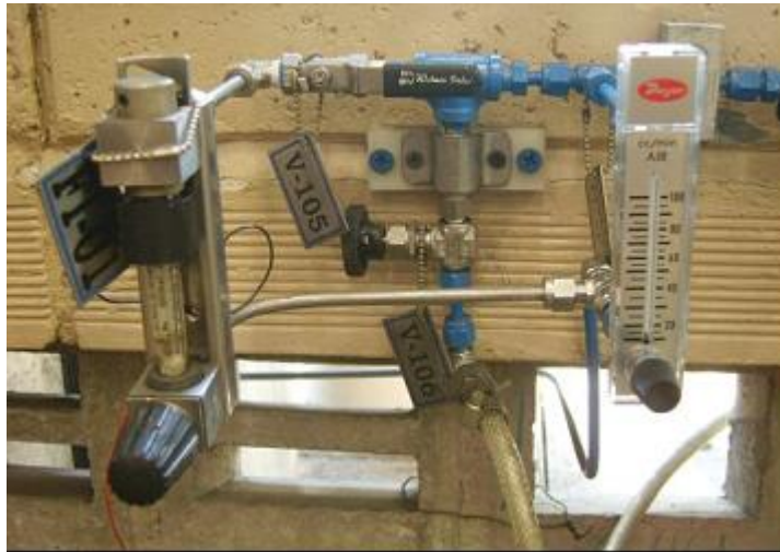
Figura 25 Sistema de rotámetros en paralelo
