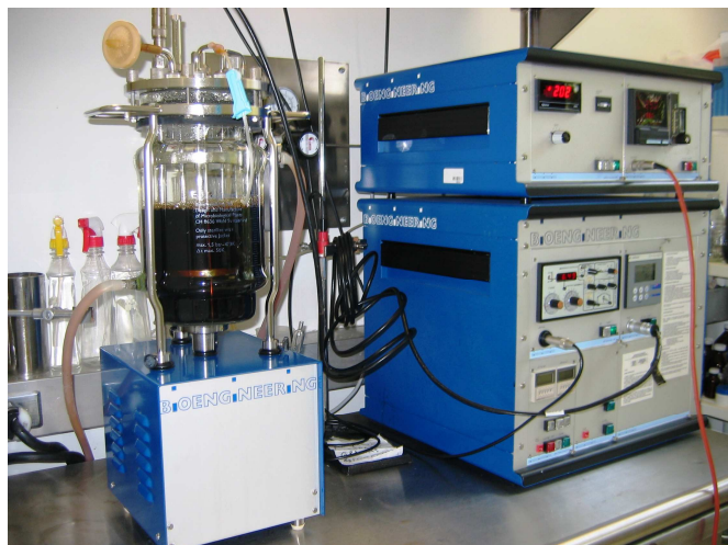
Figura 6. Montaje de fermentación para S. cerevisiae
