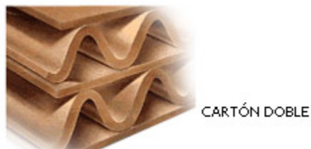
Figura 8. Estructura del cartón corrugado doble. Fuente: http://www.papelnet.cl/documentos/papelnet_carton_corrugado.pdf
