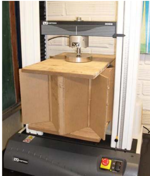
Figura 58. Montaje de pruebas de compresión, Universidad Eafit
