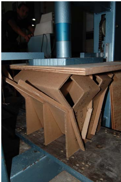
Figura 63. Fallo en prueba de compresión, prueba 3.
