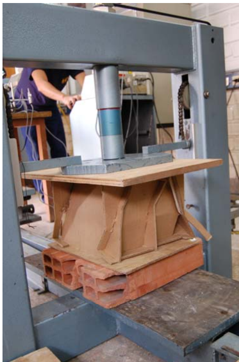
Figura 64. Fallo en la prueba de compresión, prueba 4.
