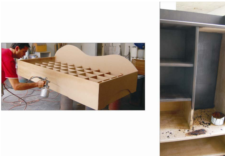
Figura 55. Aplicación de sellante y pintura. Fuente: Elaboración propia.
