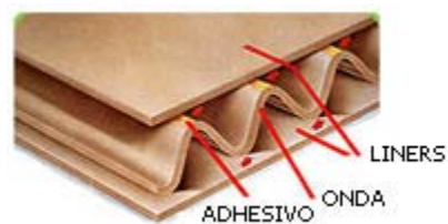
Figura 7. Partes del cartón corrugado Fuente: http://www.papelnet.cl/documentos/papelnet_carton_corrugado.pdf
