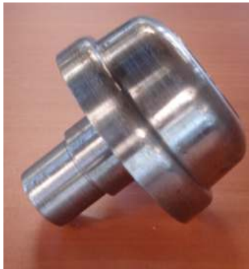
Foto 8. Molde a utilizar para prueba de repujado mediante CNC
