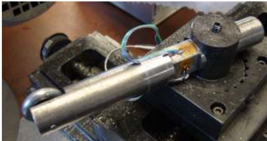
Foto 11. Galga de lámina en la herramienta para mediciones en las pruebas
