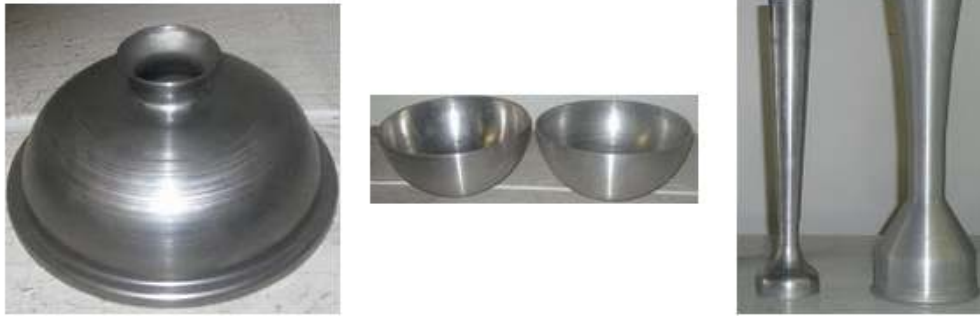
Foto 3. Piezas obtenidas por repujado tradicional
