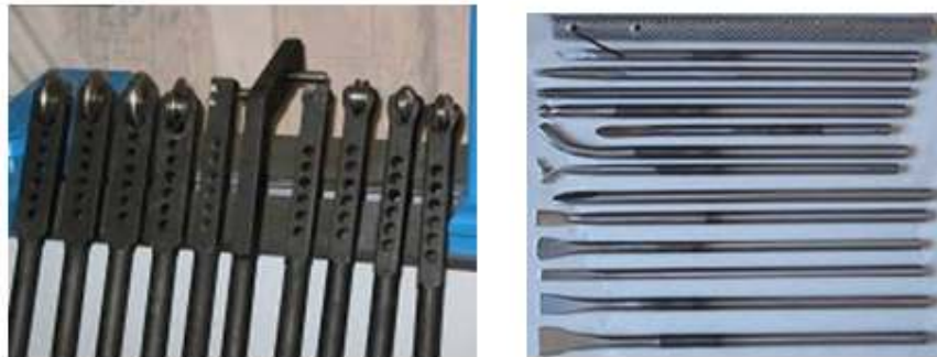
Foto 2. Herramientas de rodillo para repujado tradicional (Fuente: Metalmecánica 2009)
