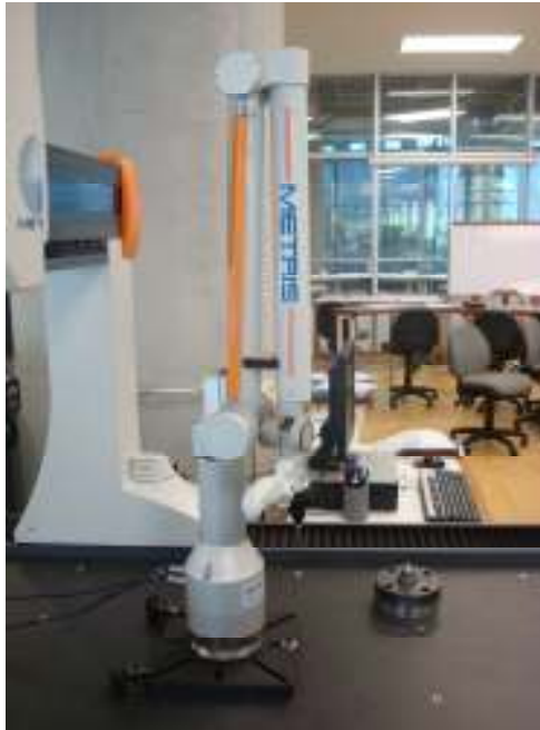
Figura 10. Brazo portátil de 7 ejes marca METRIS del Laboratorio de Metrología Universidad EAFIT.
