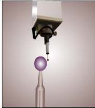
Figura 8. Rutina de calibración del palpador
