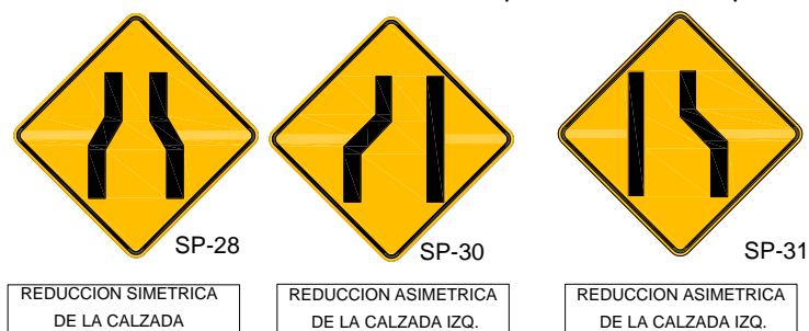
Figura 3.11. Señales preventivas de reducción de calzada.
