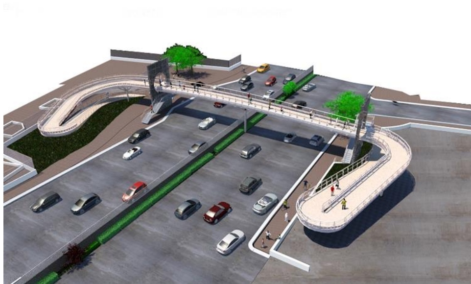
Figura 6.11. Paso peatonal a desnivel.
