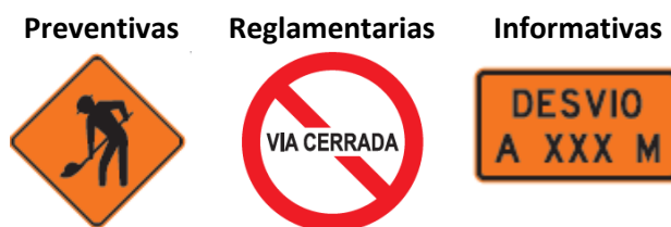
Figura 8.17. Ejemplos de señales verticales de obra.
