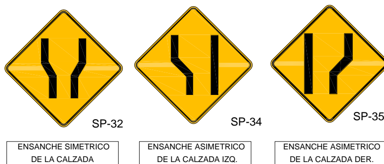
Figura 3.12. Señales preventivas de ensanchamiento de calzada.
