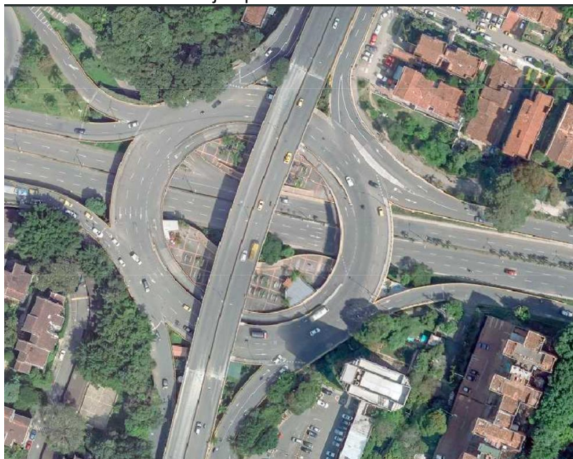
Figura 5.56. Glorieta a desnivel.
