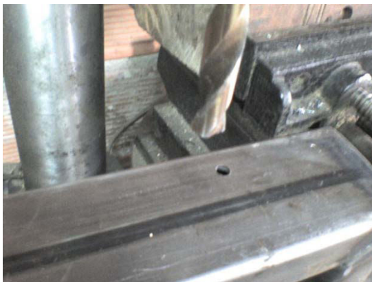
Fotografía 31. Perforación tubería y láminas
