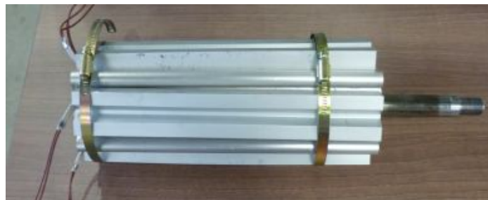
Figura 9 Cilindro con resistencias de calentamiento acopladas
