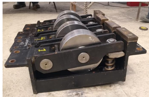
Foto 1. Ruedas contraguía con resorte helicoidal
