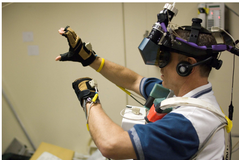
Figura 1: Uso típico de la RV. El usuario lleva un HMD para los ojos, guantes de datos y sensores tracker en cabeza y manos.
