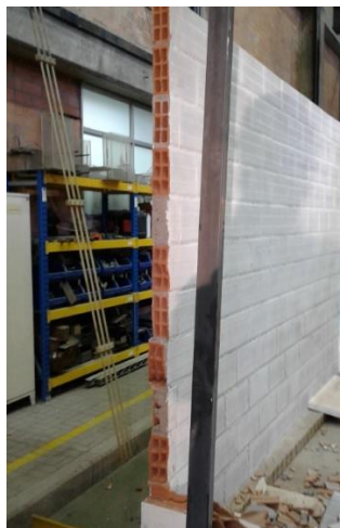
Figura 6.10 Conexión lateral luego de la falla del ensayo 4-T2-7-408-0-S
