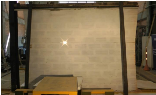
Figura 6.16 Momento exacto de la falla del muro del ensayo 5-T1-7-325-0-S (vista sur)
