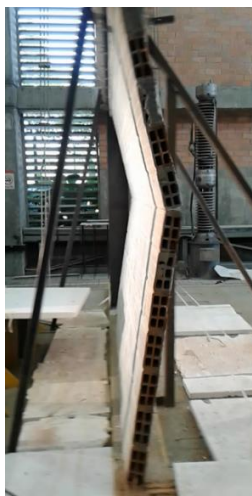
Figura 6.17 Momento exacto de la falla del muro del ensayo 5-T1-7-325-0-S (vista este)
