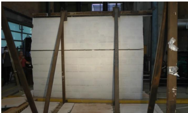
Figura 6.15 Momento exacto de la falla del muro del ensayo 5-T1-7-325-0-S (vista norte)
