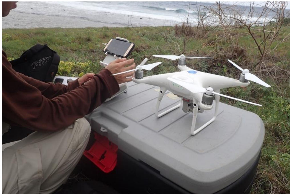
Figura 11. Drone DJI Phantom 4Pro, utilizado para realizar el levantamiento de terrazas marinas emergidas.
