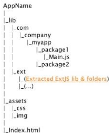
Figura 30. Estructura de una aplicación con ExtJS. Tomado de (Chandan, 2011)
