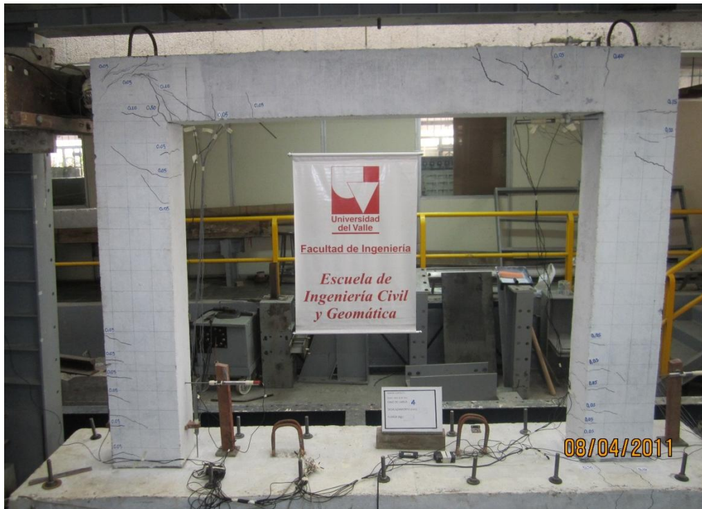
Figura 7.1. Estado final del pórtico P1
