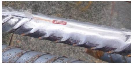
a) Pulida de superficie y pegado de galga
