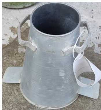
Figura 5. Cono para medir asentamiento
