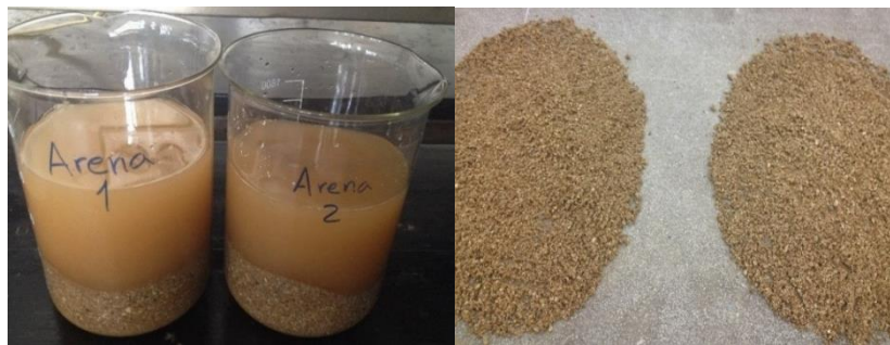
Figura 27. Procedimiento de absorción y densidad de la arena
