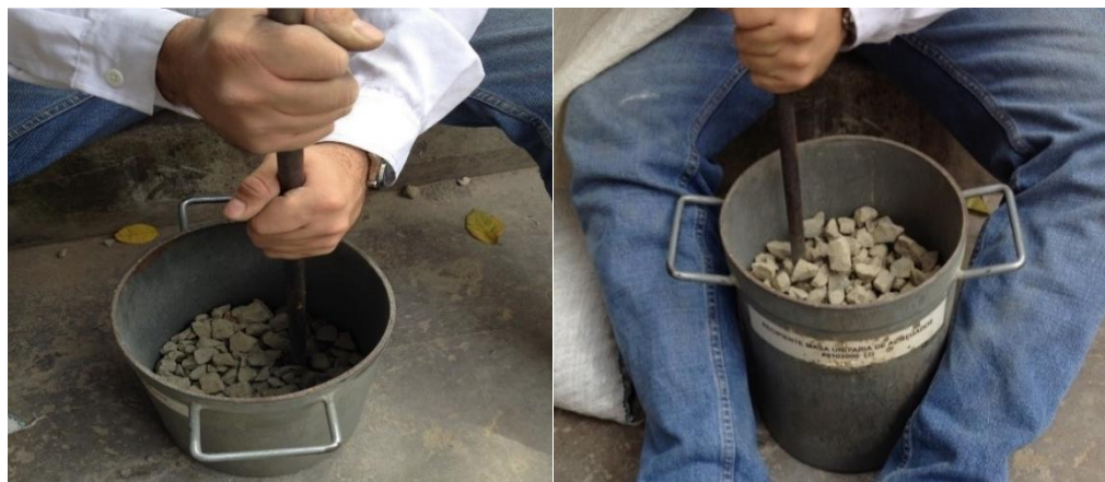
Figura 29. Procedimiento por apisonamiento
