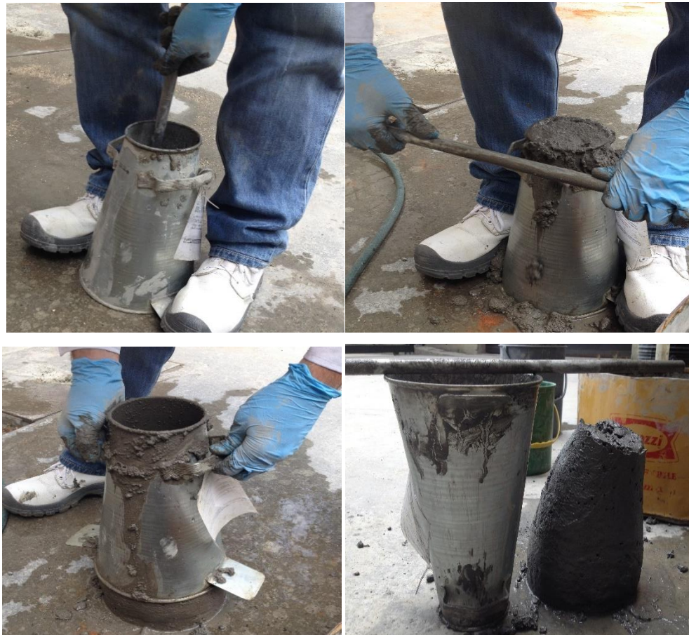
Figura 31. Ensayo de asentamiento
