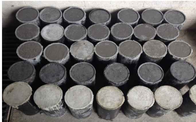
Figura 12. Cilindros de concreto
