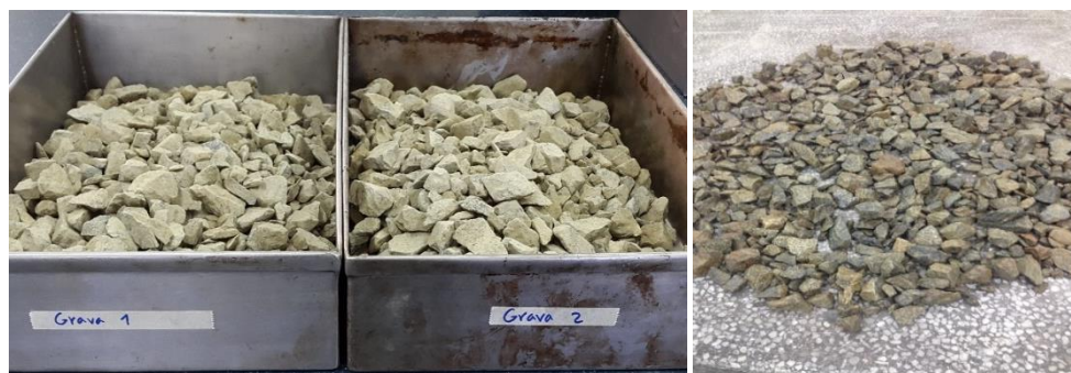
Figura 28. Procedimiento de absorción y densidad de la grava
