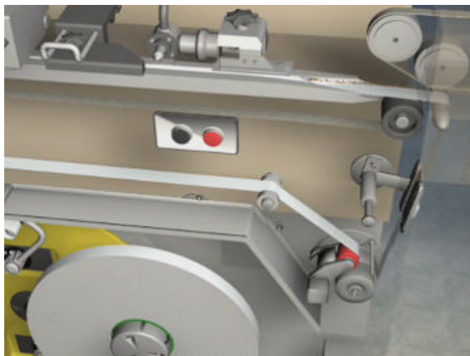
Figura 10. Formación de columna de tabaco en elaboración de cigarrillo.
