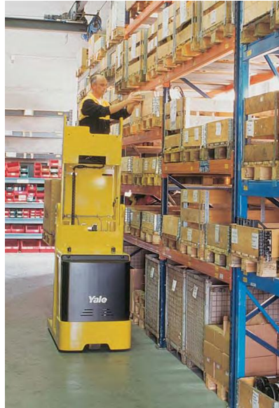
Figura 23. Montacargas order picker en operación.
