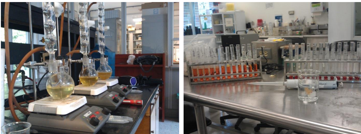
Figura 8. Montajes realizados para la hidrólisis ácida.
