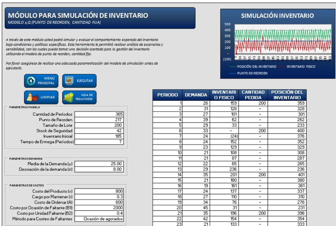
Figura 21. Ventana de simulación para el modelo de punto de reorden y cantidad fija a ordenar ( $s,Q$ ).
