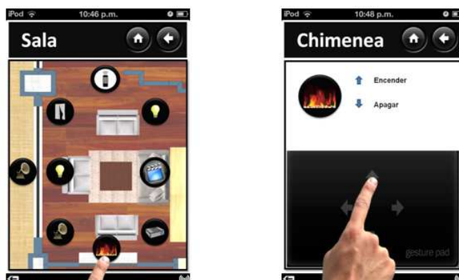
Gráfica 22. Interfaz para el control de la chimenea
