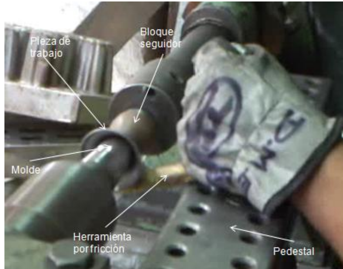
Ilustración 2. Configuración repujado manual
