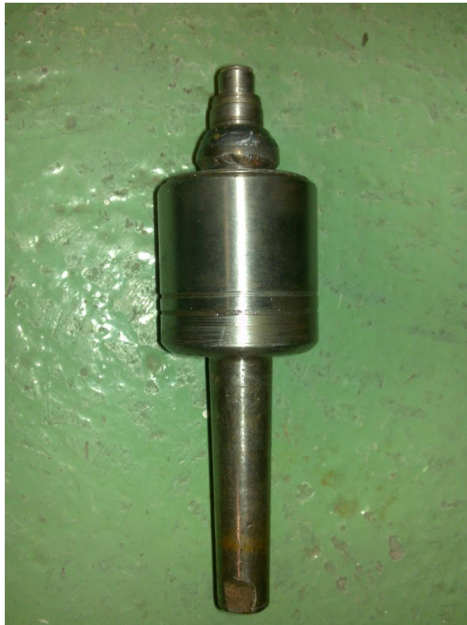
Ilustración 33. Punta giratoria con geometría cilíndrica
