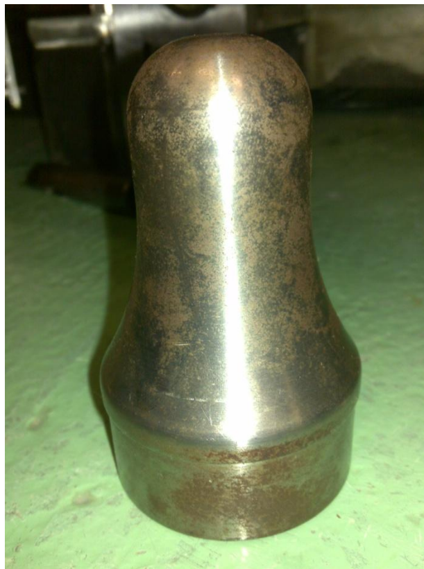
Ilustración 5. Molde en acero de una campana
