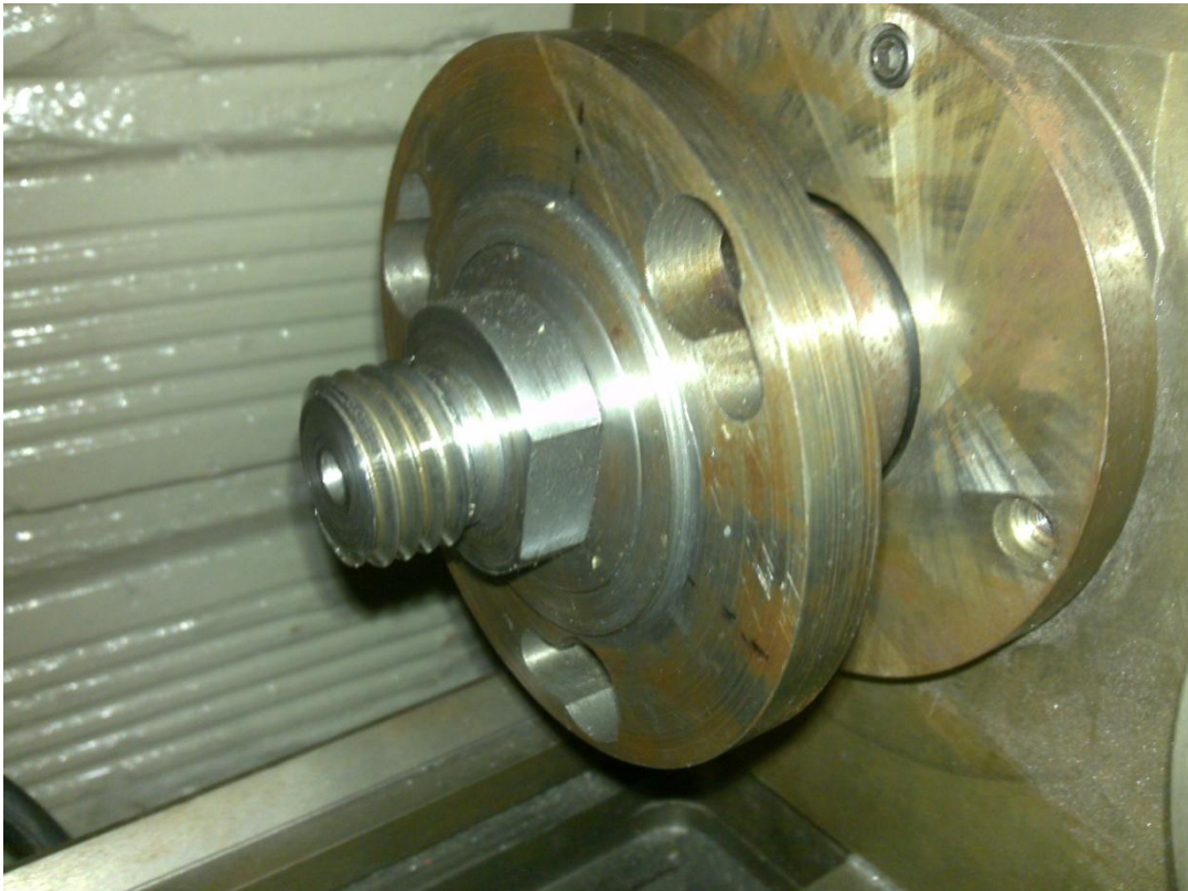
Ilustración 32. Husillo roscado para montaje de moldes
