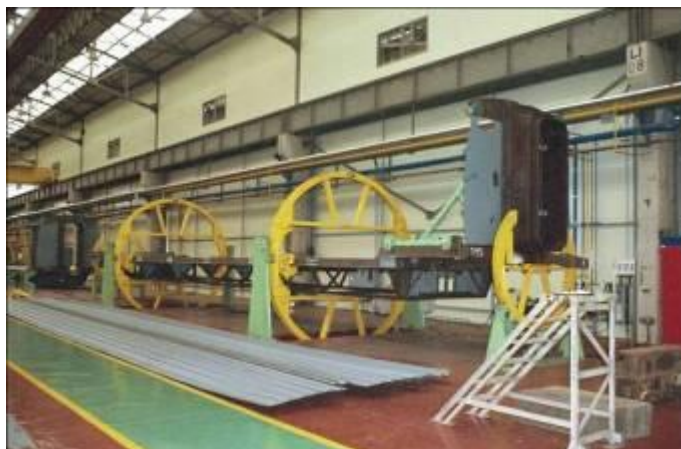
Ilustración 18. Extremos del vagón soldados en el bastidor
