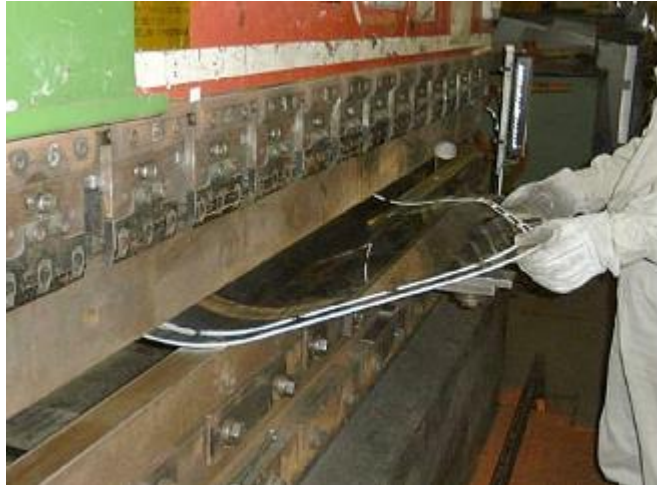
Ilustración 22. Proceso de plegado de un panel exterior
