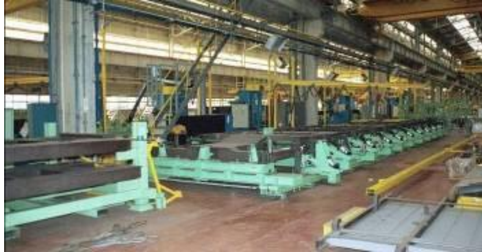
Ilustración 16. Bastidor rotado listo para soldar más componentes
