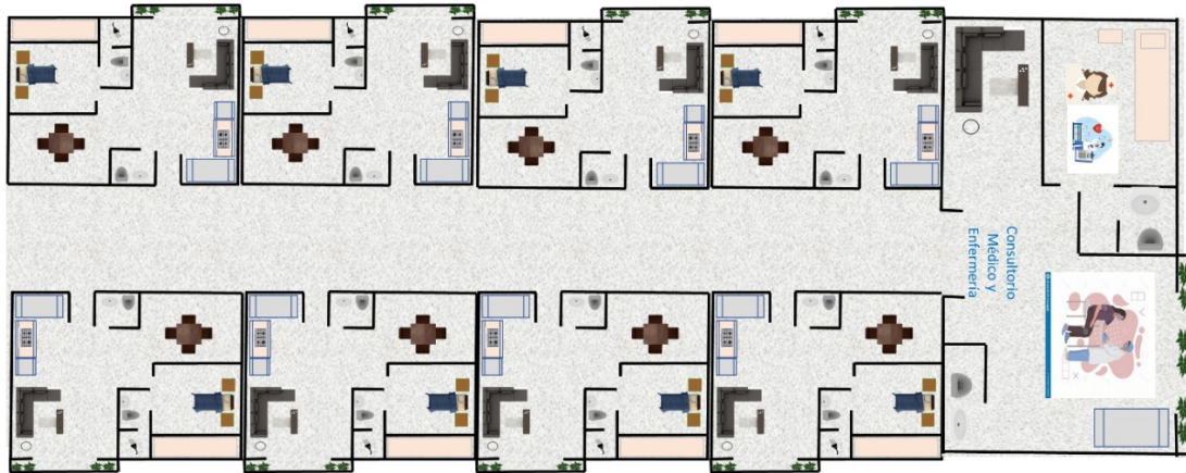
Gráfico 33. Planta del segundo nivel torre de la central - Ocho apartamentos de 40 m 2 de tipo 3 y consultorio médico y de enfermería
