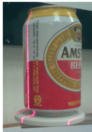
Figura 31: El escáner 3D haciendo un recorrido con el láser por el objeto a escanear
