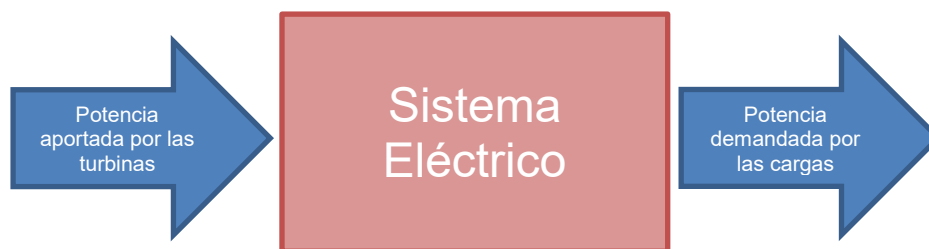
Figura 1. Balance de energía en un Sistema Eléctrico
