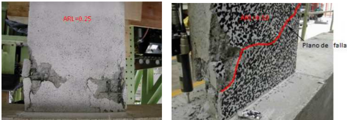
Figura 19. Comparativo falla muros con ARL=0.25-0.50 . Fuente: Su y Wong (2007, citados en Bonett, 2018a).
