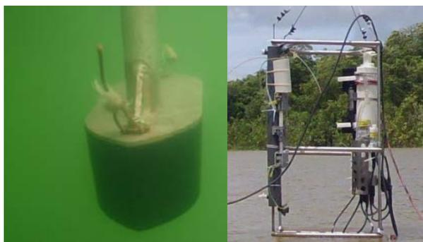
**Figura 12. Equipos de medición. Transductor de ecosonda (izq.) y Botella Niskin y CTD (der.)**
