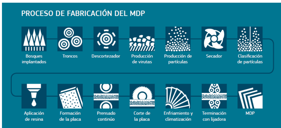
Imagen 16. Proceso de fabricación del MDP
