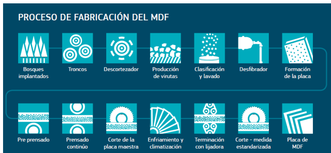
Imagen 15. Proceso de fabricación del MDF
