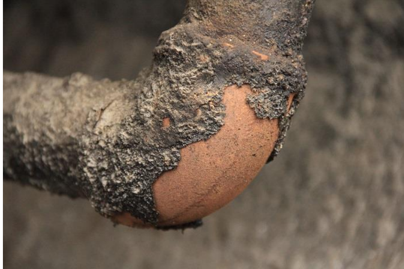
Figura XIII. Aglomeración de partículas de asfalto caucho en tubos de calentamiento
