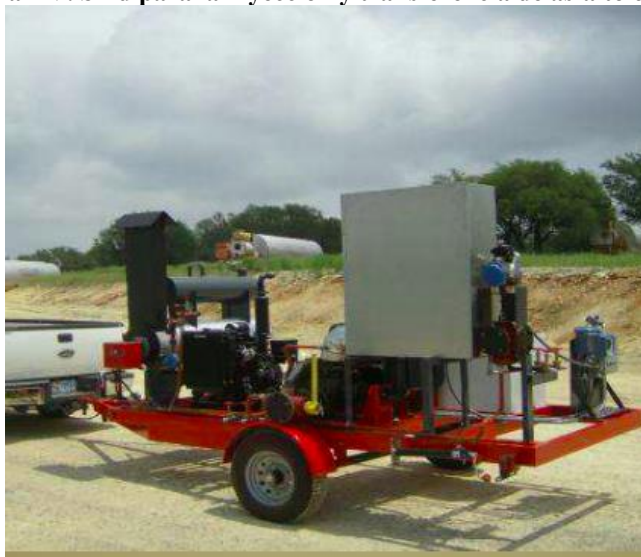
Figura XV. Skid para la inyección y transferencia de asfalto caucho
