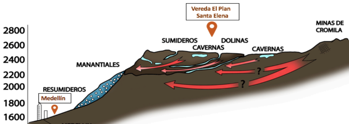
Figura 2. El dibujo muestra la relación hidro-geológica entre las geformas kársticas de la vereda El Plan y los depósitos de Vertiente localizados en las laderas Orientales de Medellín. Tomado y modificado de Rodríguez (1989).
